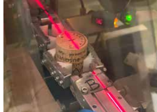
Control de qualitat manual de taps de suro i màquina de troquelar taps, a Costa Quer. Marcatge amb làser d'un tap de cava d'Alta Alella a Francisco Oller.
