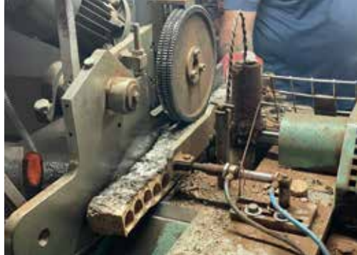
Control de qualitat manual de taps de suro i màquina de troquelar taps, a Costa Quer. Marcatge amb làser d'un tap de cava d'Alta Alella a Francisco Oller.
