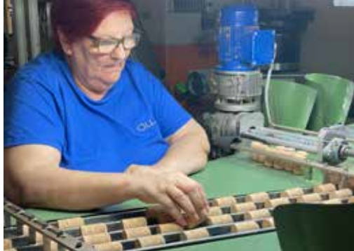
Control de qualitat manual de taps de suro i màquina de troquelar taps, a Costa Quer. Marcatge amb làser d'un tap de cava d'Alta Alella a Francisco Oller.
