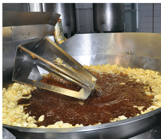
A la dreta, de dalt a baix: Les patates, un cop pelades, es renten amb aigua (Patates Torres). Una cinta transportadora aboca les patates ja tallades dins la fregidora a Corominas. Un mecanisme remou les patates mentre es fregeixen (Patates Torres). Un operari de Corominas usa l'espàtula per treure els xips de la fregidora.
